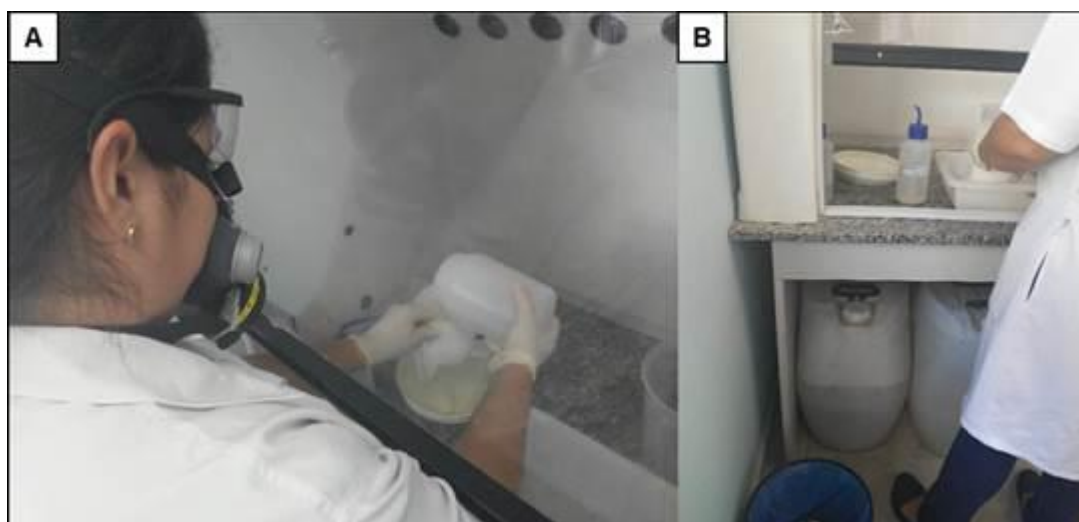
Figura IV.6.2.2.2-1 – (A) Retirada do formaldeído em capela com uso de EPI; (B) Bombonas de armazenamento do formaldeído para descarte.
