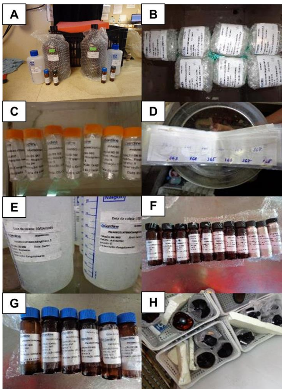
Figura III.3.1.2.2-2 – (A) Frascaria utilizadas no acondicionamento dos diferentes parâmetros coletados na água do mar; (B) filtros para COP/MPS; (C) filtros para fitopigmentos em tubos criogênicos (D) filtros para Carbono 14; (E) frascos para nutrientes; (F) frascos para COD; (G) frascos para COT e (H) frascos para hidrocarbonetos.
