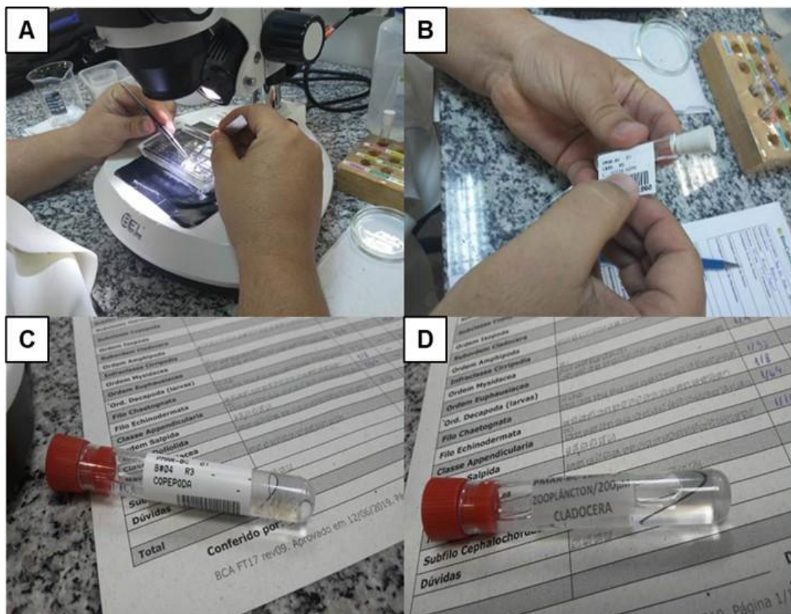
Figura IV.6.2.2.4-2 – (A) Triagem dos organismos; (B) Colagem dos códigos de barra nos frascos; (C) Identificação dos frascos com códigos de barra; (D) Etiquetas internas nos frascos.
