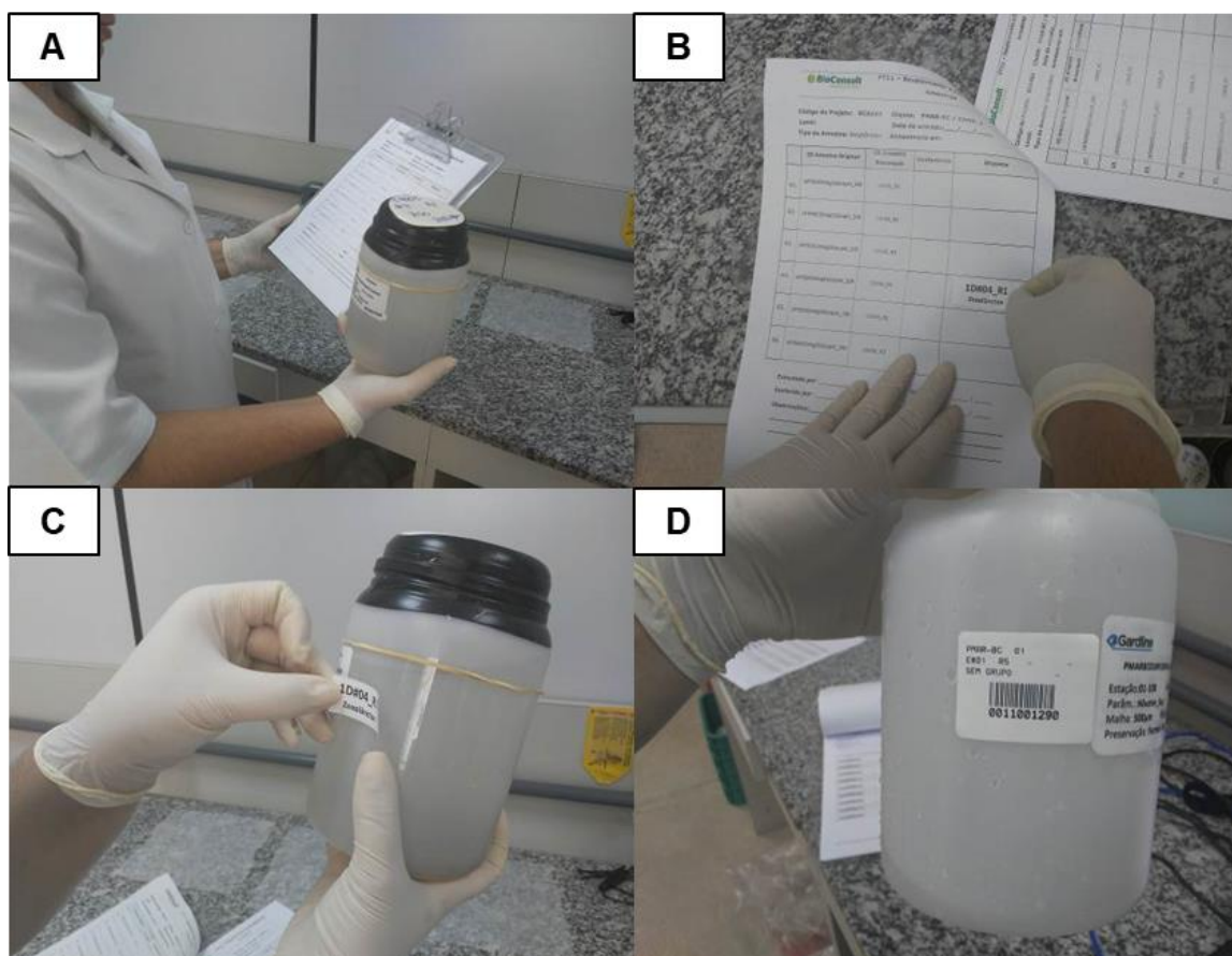
Figura IV.7.2.2.1-1 – (A) Conferência da integridade da amostra e código; (B) Atribuição de código interno à planilha; (C) Atribuição do código interno à amostra; (D) Registro no sistema e geração do código de barras.
