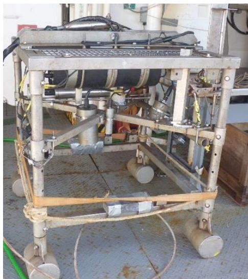
Figura III.3.1.3.2-2 – Equipamento para imageamento Drop Câmera utilizado na primeira campanha do Projeto de Monitoramento Ambiental Regional da Bacia de Campos (PMAR-BC).
