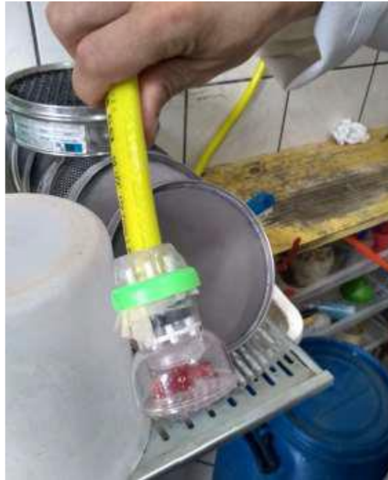
Figura IV.13.2.2.1-2 – Torneira utilizada para lavagem das amostras. No detalhe é possível visualizar a malha de 0,030 mm utilizada para filtragem de organismos de água doce.
