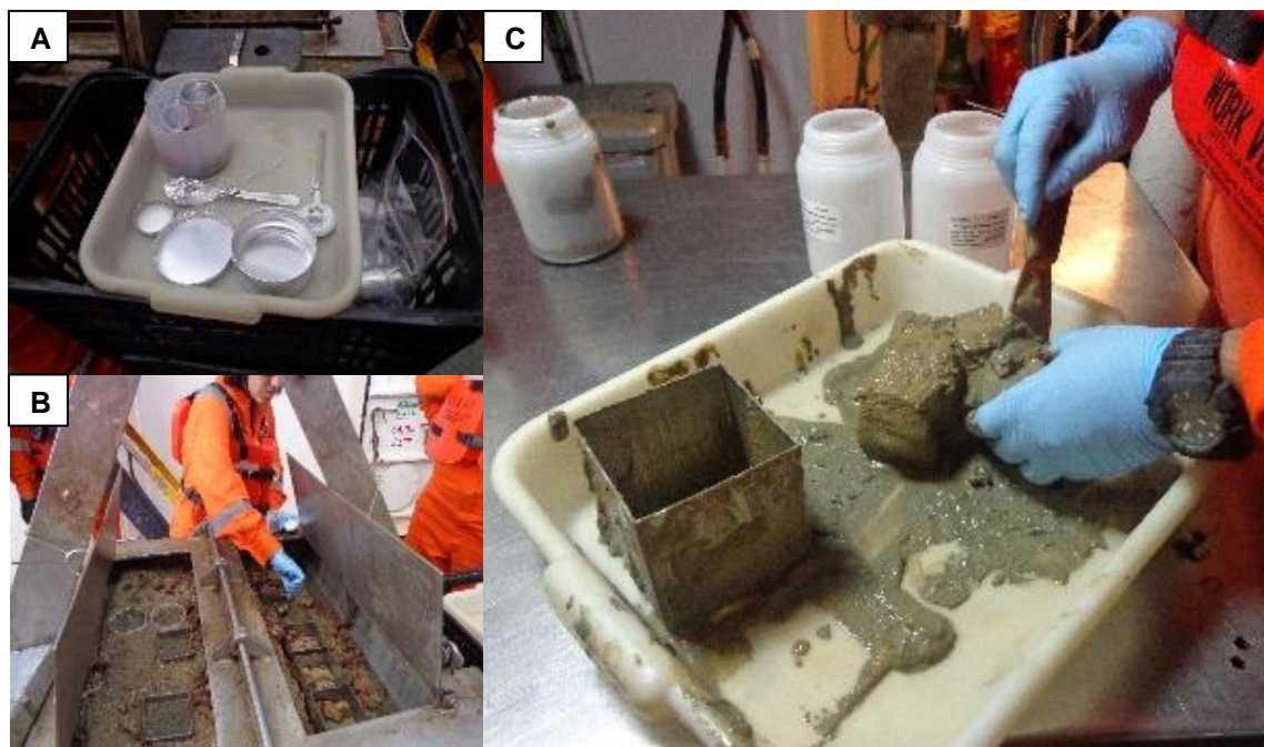
Figura III.3.1.3.2-7 – (A) Frascaria utilizadas no acondicionamento dos diferentes parâmetros coletados no sedimento; (B) Coleta das subamostras para análises químicas retiradas diretamente do amostrador; (C) subamostras para análises biológicas a partir dos gabaritos retirados do amostrador.
