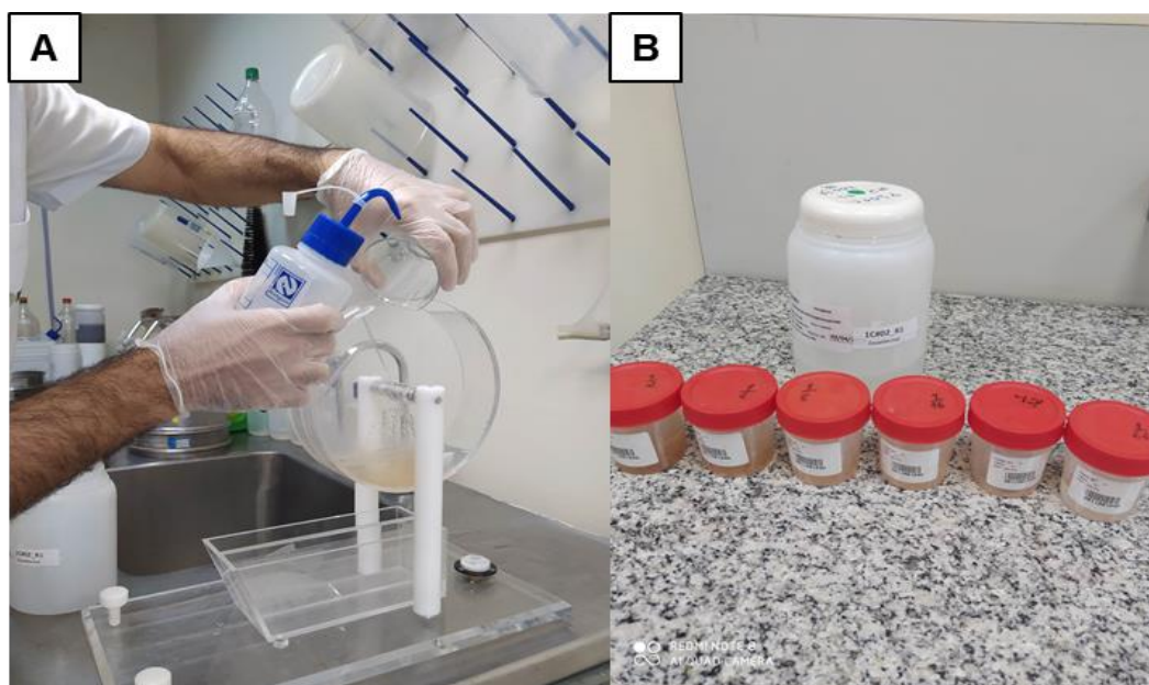
Figura IV.6.2.2.4-1 – (A) Fracionador Folsom; (B) Amostra com as diferentes frações.
