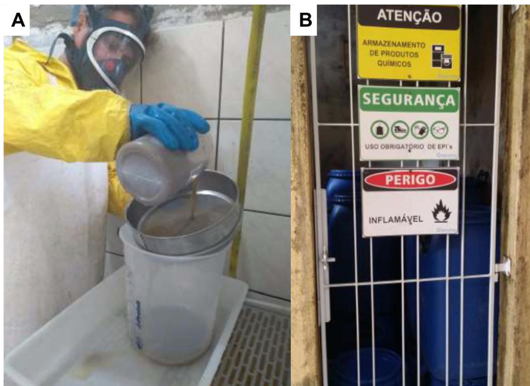
Figura IV.13.2.2.1-1 – (A) Retirada do fixador utilizando-se peneira de 0,045 mm, Becker de 4L e bandeja para contenção. (B) Bombonas para armazenagem de formol.
