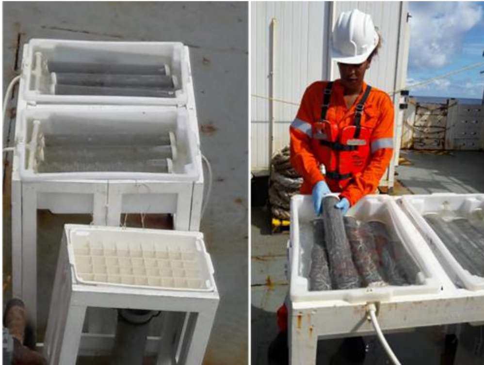
Figura IV.5.2.1-1 - Incubador com 8 níveis de luz montado no deck do navio para a determinação da produtividade primária.
